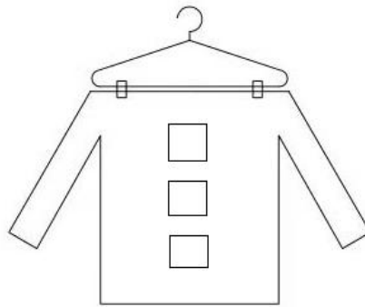
图 B.1 试验样块位置图（背面三等分点）
